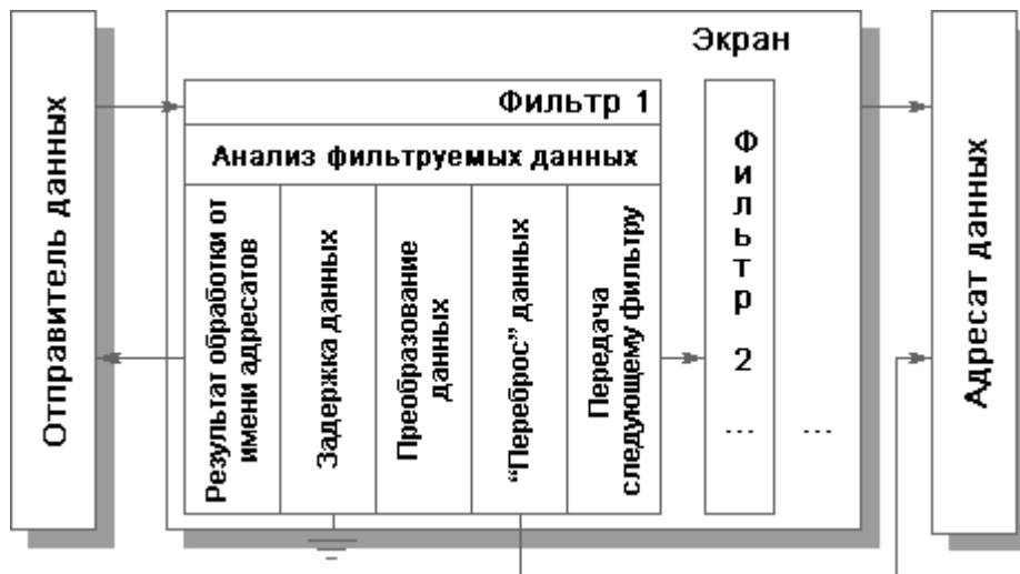
Рис. 7. Экран как последовательность фильтров.
